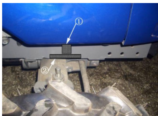
(1) Паспортная табличка трактора (2) Серийный номер трактора
