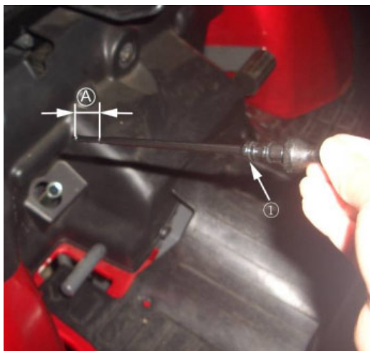
(1) Измеритель (А) Уровень масла должен находиться в пределах этого диапазона.
