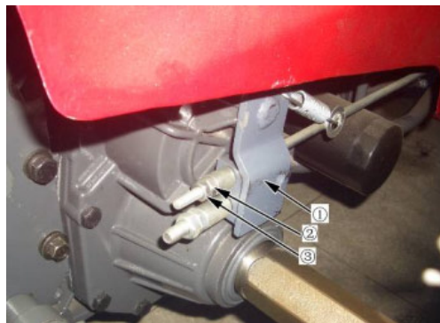
(1) Рычаг тормоза (2) Регулировочная гайка (3) Контргайка
