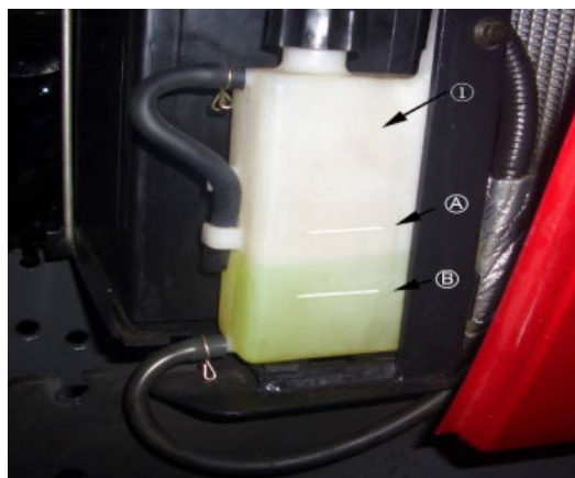
(1) Бак регенерации (A) «ПОЛНЫЙ» (FULL) (B) «НИЗКИЙ» (LOW)
